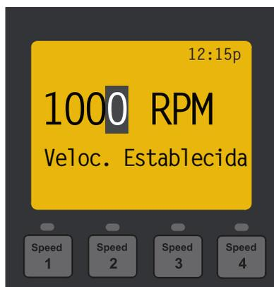
Configuración de la velocidad de la bomba en modo Anti Freeze
